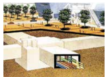
共同溝システムのイメージ図 Common duct system image diagram
