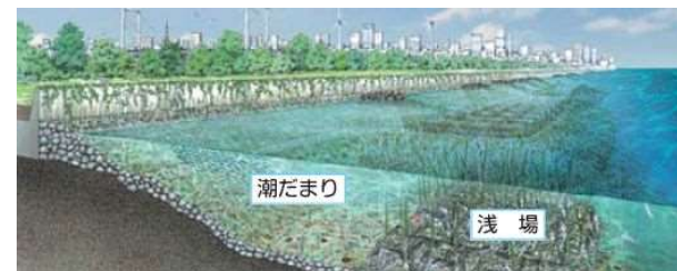
緩傾斜護岸を活用した浅場等の整備
