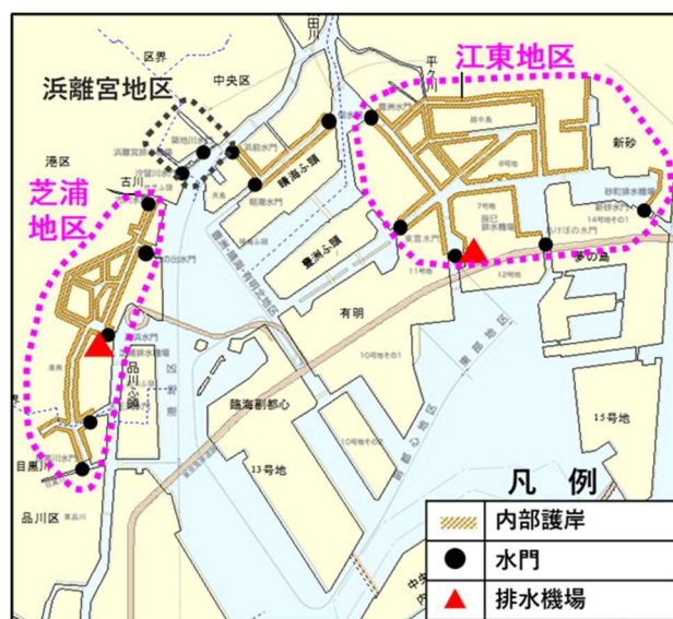
排水機場を要する地区
