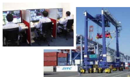
図 23 遠隔操作RTGによる荷役作業
