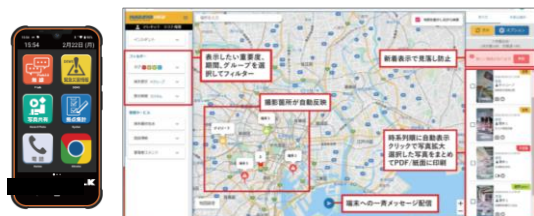
災害用IP無線(被害状況をリアルタイムでWEB上に共有)
