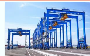
FC換装型RTG (出典)住友重機械搬送システム株式会社ウェブサイト
