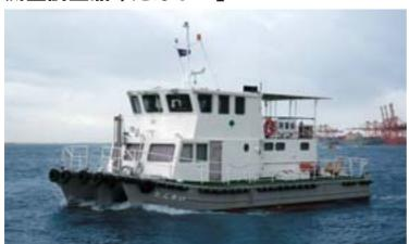
[船主要目] 種類 / 汽船 船質 / 鋼 全長 /14.50m 幅 /6.2m 深さ /2.02m 総トン数 /32t 航行速力 /11.8 ノット 航行区域 / 平水区域 船用ディーゼル機関 440PS×2基
