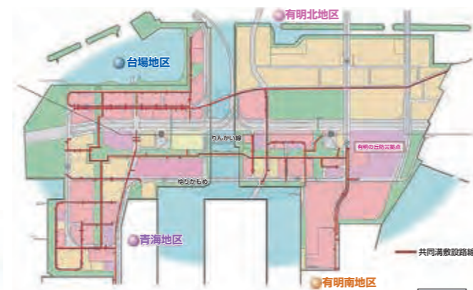
臨海副都心に整備された共同溝 Common ducts within Tokyo Waterfront City
