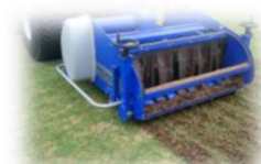
フェアウェイ 土壌固結改善 特殊機械でエアレーションと目 砂を同時に行うことで、機械の 作業走行を半減させ、芝や土 壌への加重負荷を抑える
