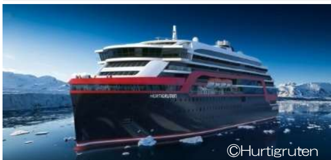
ロアール・アムンセン (ディーゼルとバッテリーのハイブリッド 推進システムを搭載)
