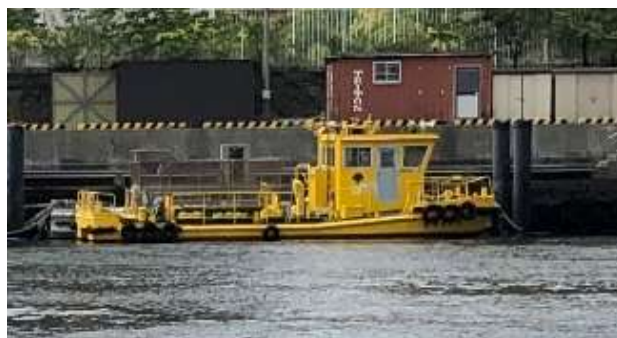
海面に浮遊するごみを回収
