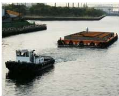
土砂や工事資材を運搬する船舶 資料：東京はしけ運送事業協同組合HPより
