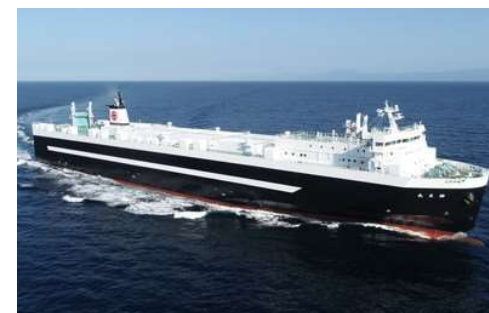
【リプレース後】 船長：190m 総トン数（GT）：13,650トン シャーシ：192台 乗用車：200台
