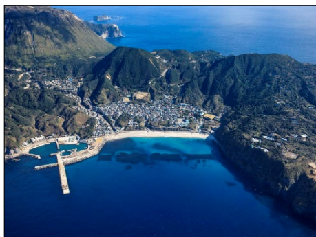
神津島港海岸(港湾海岸) 景観に配慮した離岸堤(潜堤)の設置が進む砂浜で、集落に近く賑わいのある海水浴場として利用
