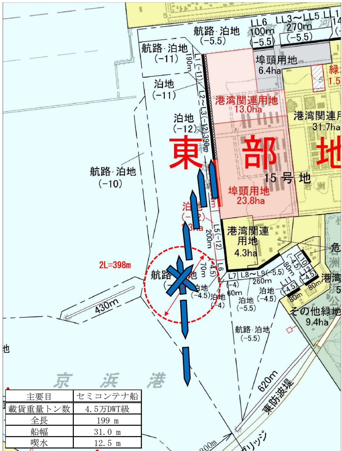
図Ⅲ-6-8 15号地木材埠頭の回頭水域・操船例図（L4出港時）
