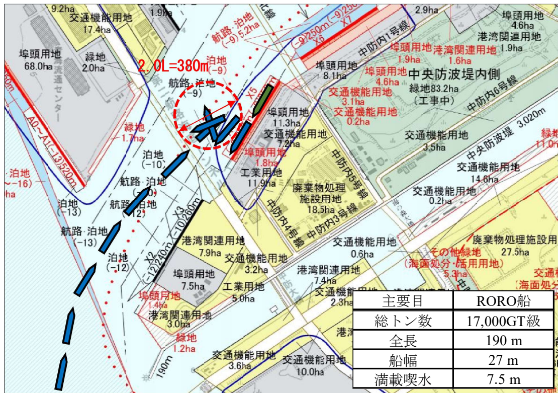
図 III-6-9 中央防波堤内側内貿ユニットロード埠頭の回頭水域・操船例図（入港時）
