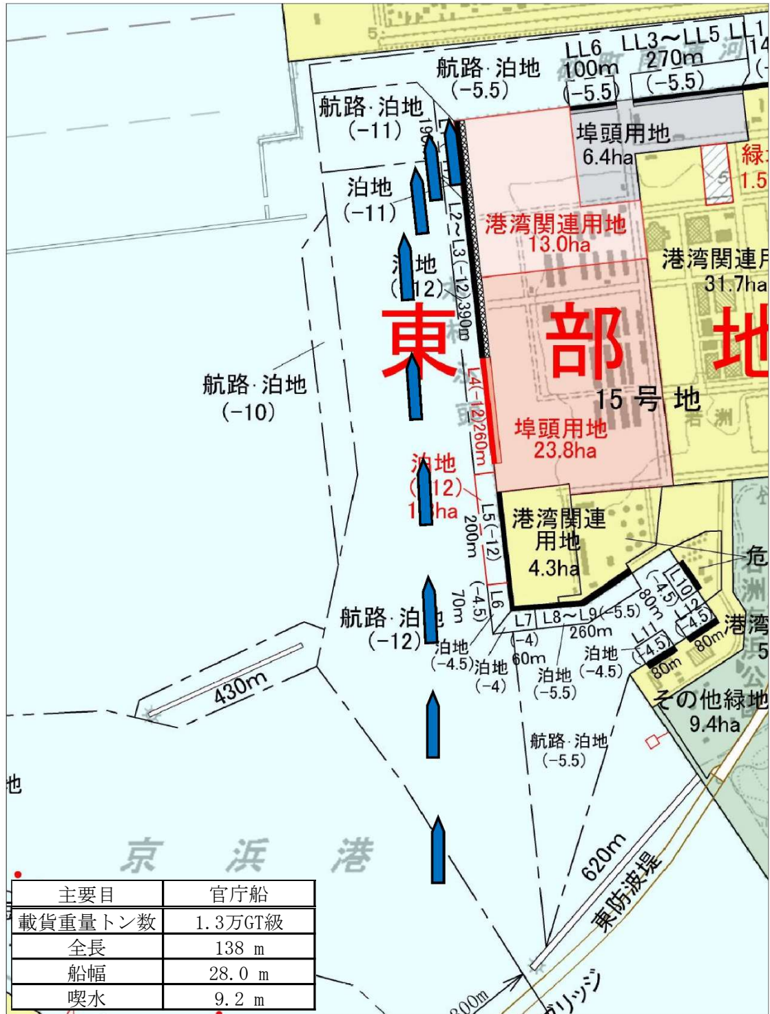
図Ⅲ-6-3 15号地木材埠頭の回頭水域・操船例図 (L1入港時)
