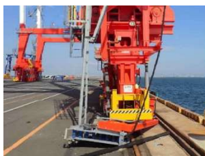
図 I-2-22 平成30年の台風21号による神戸港の被災状況 (ガントリークレーンのケーブルリール落下状況)
