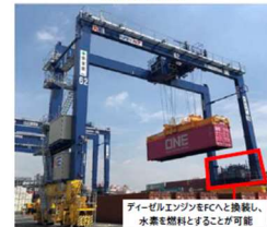
※ 国際海上コンテナを扱う荷役機械であるタイヤ式トランスファークレーン(Rubber Tired GantryCrane)の略称
