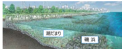
緩傾斜護岸を活用した磯浜等の整備
