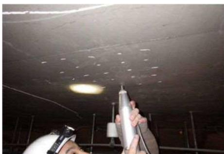
写真 2-11 コンクリートの強度調査
