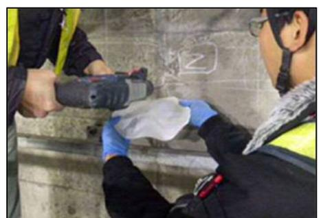
写真 2-12 コンクリートの塩害調査
