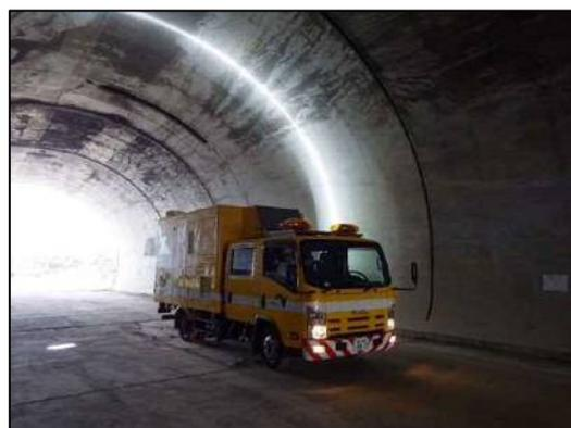
写真5-2 高速走行型レーザー搭載車両による計測イメージ
