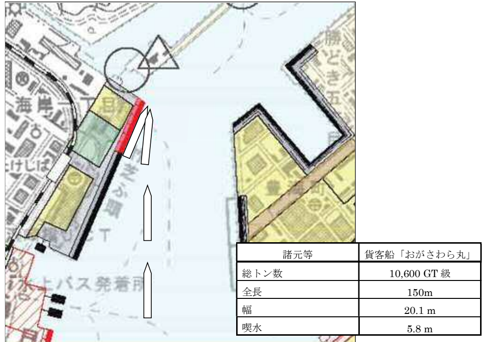
図Ⅲ- 6-3 竹芝ふ頭前面の回頭水域・操船例図（入港時）
