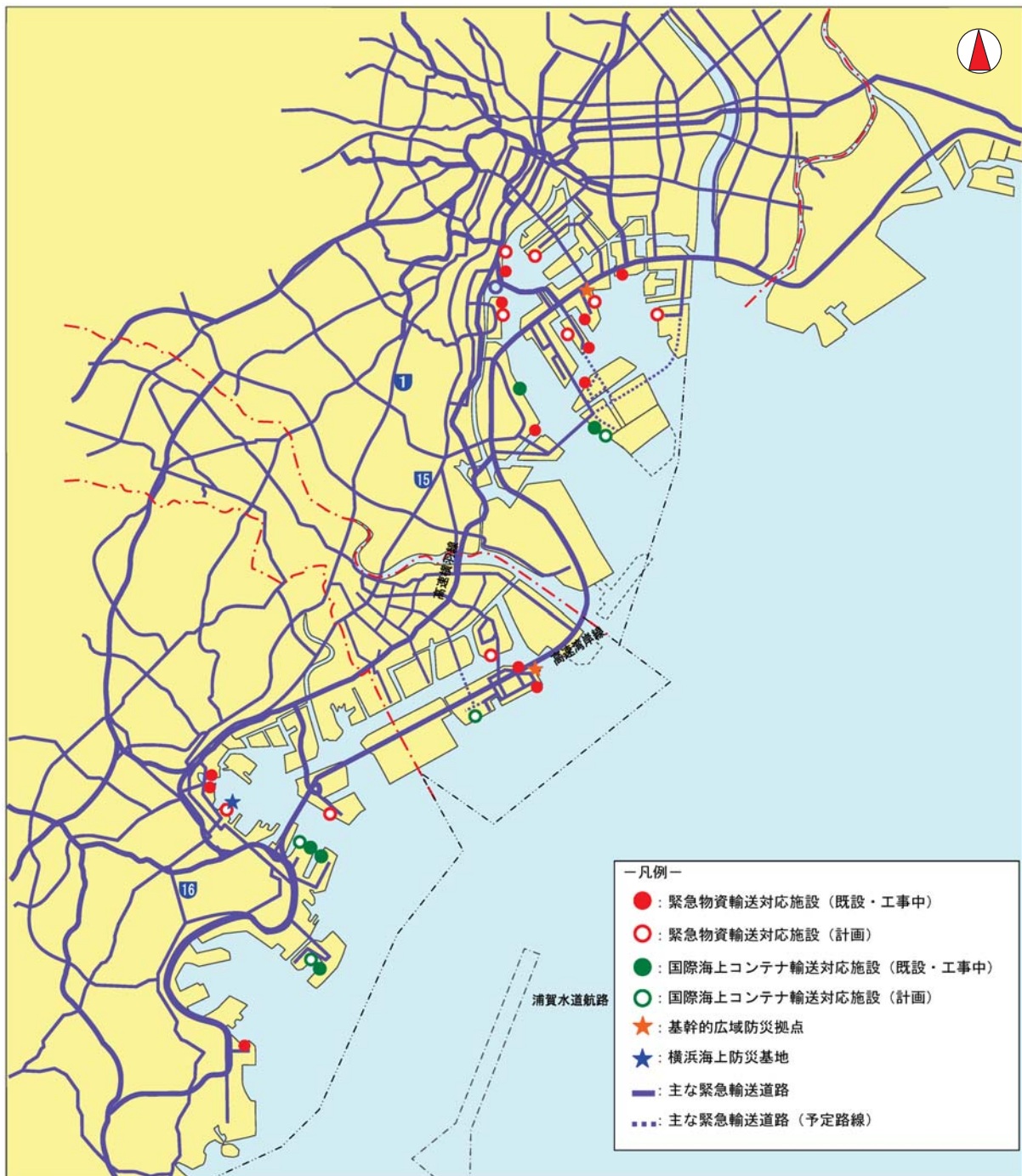
図表 51 緊急輸送道路ネットワークと三港の耐震強化岸壁
