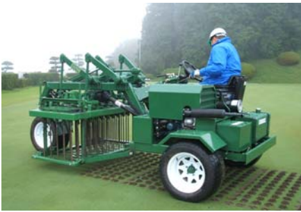
図1 日本に数台の先進機械「ディープドリル」で、グリーン地盤の固化現象を緩和
