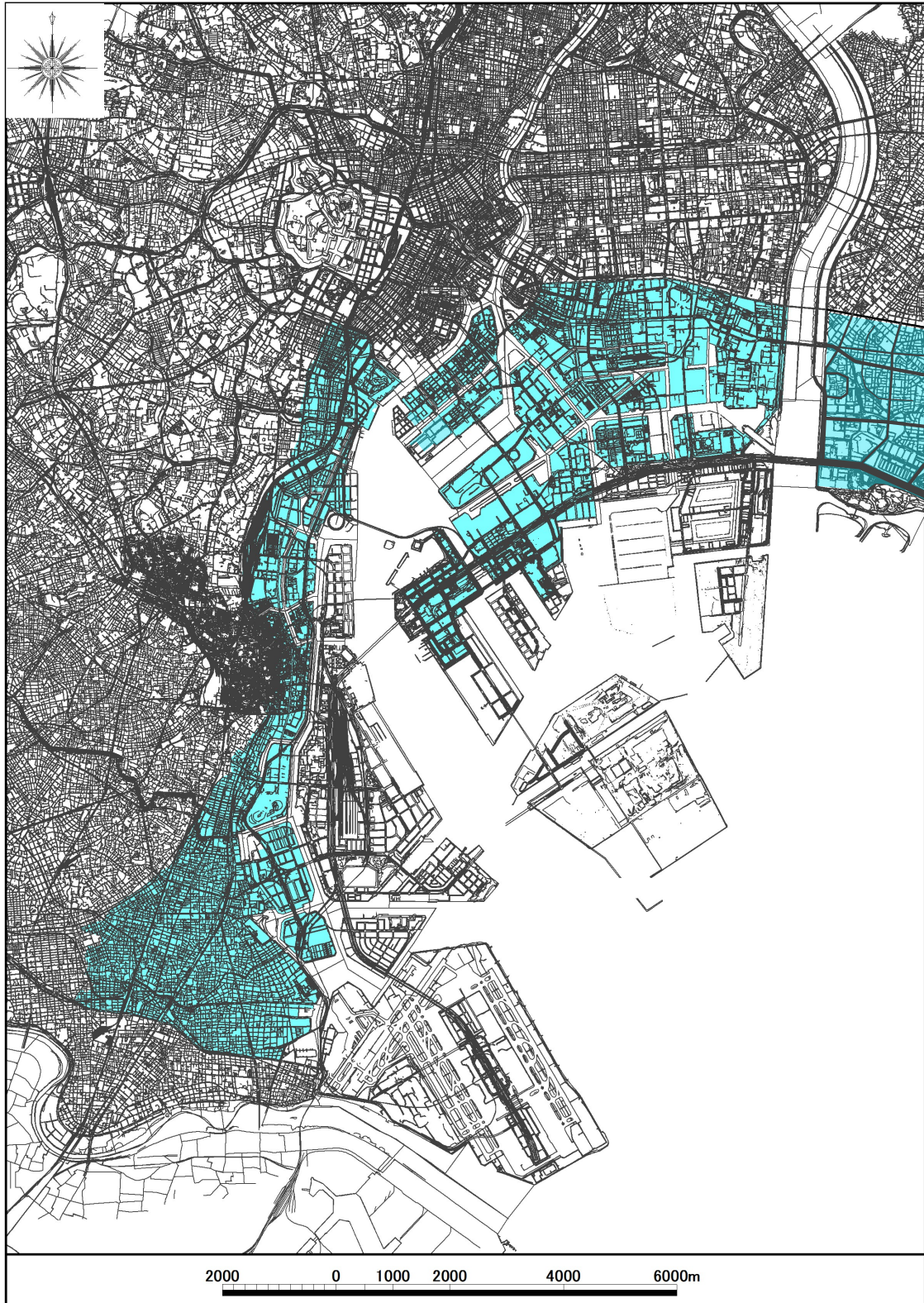
図 3-3 海岸保全施設整備により高潮等から防護される沿岸部区域
