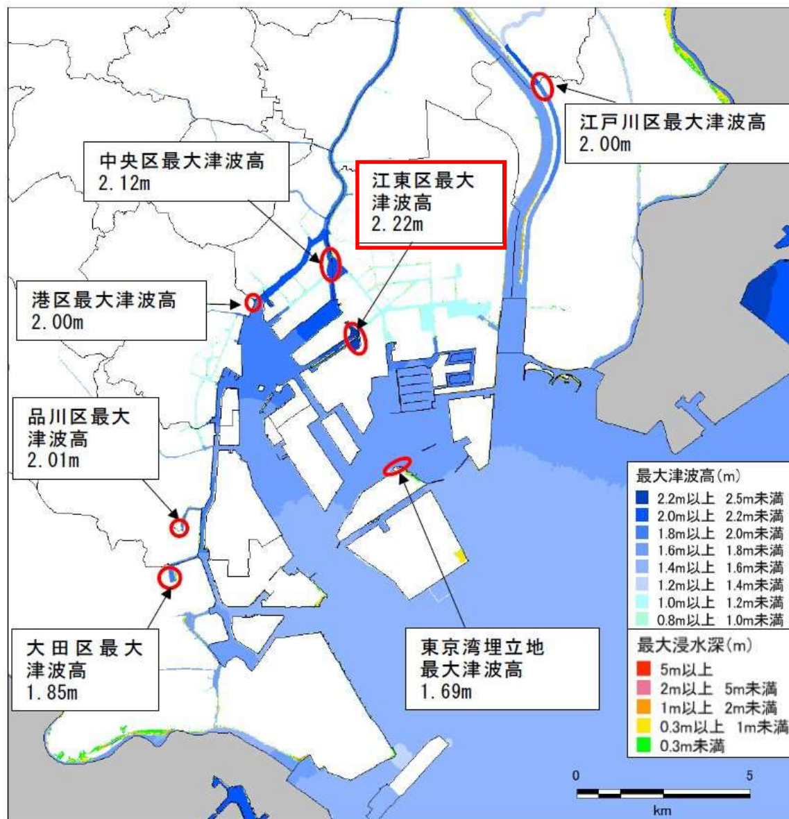
図 5-2 大正関東地震の各区における最大津波高とその場所
