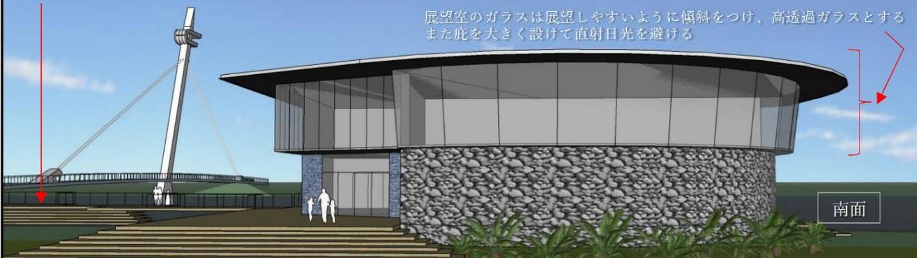
建物周囲は盛土をせずに（建物内への砂侵入防止）、木製ウッドデッキと浜辺の植生にあった低木で高低差を調整する／南面に開かれたアプローチ
