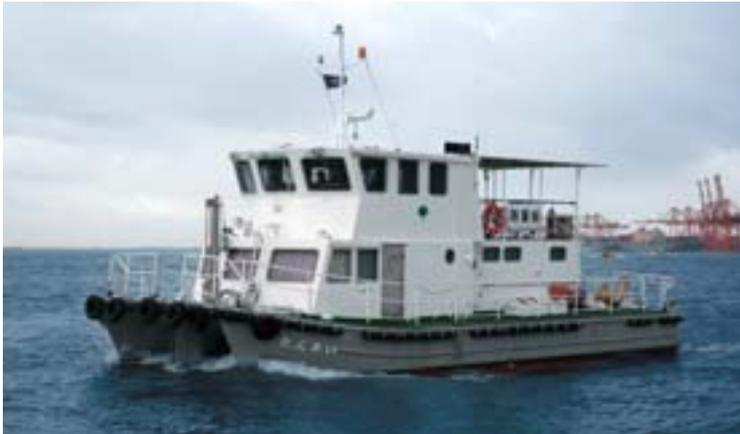
「たんかい」は、東京港内の航路等の深淺測量を定期的実施し、しゅんせつ作業前後の海底の状況（土砂の堆積、海底地形の変化等）を調査します。主な特徴として、マルチビーム測深機を搭載し、海底状況を立体画像に変更した情報を東京港の航行安全や浚渫事業に活用しています。
