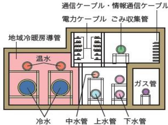
上下水道をはじめ、電気、ガス、情報通信などのライフラインについては、**耐震性を備えた共同溝に収容することで、安定供給を確保**しています。
