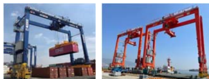
水素燃料電池(FC)換装型RTG
